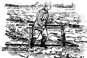
Спасательная лестница с вертикальными стойками и поручнями.
